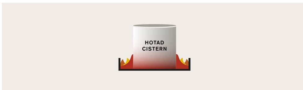
Figur 3. Invallningsbrand som ger direktpåverkan av flammor på hotad cistern.
