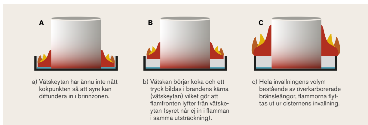
Bild 12. Figurerna ovan visar flammornas form omedelbart ovanför vätskeytan vid brand inuti invallning. Flammornas bas höjs successivt upp till invallningskrönet och volymen av oförbrända ångor ökar efter viss brinntid till dess ett jämviktstillstånd inträder i c). I en invallning med en produkt med lågt ångtryck fås sällan något stabilt jämviktstillstånd. Lågornas bas kommer då snarare vandra mellan vätskeyta och invallningskrön. /Ref. 8/.
